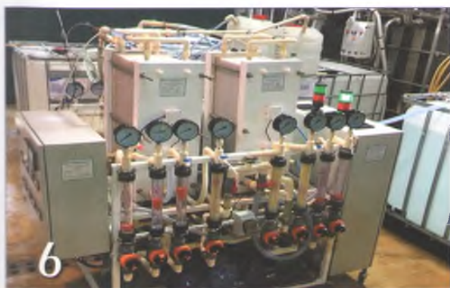
6 ТЕХНОЛОГИЯ И ОБОРУДОВАНИЕ МТЛТ ДЛЯ ДЕМИНЕРАЛИЗАЦИИ ЛАКТОЗОСОДЕРЖАЩЕГО СЫРЬЯ С ПОВЫШЕННЫМ СОДЕРЖАНИЕМ СУХИХ ВЕЩЕСТВ
